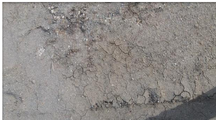
Figura 11 - Retração em solo expansivo.
