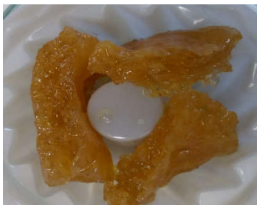
Figura 10 – Hidrogel superabsorvente sintetizado contendo Acrilamida, acetato de celulose (10%) e Montmorilonita (10%).
