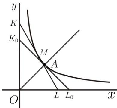
Figura 2.17: Ponto de tangência divide o segmento em duas partes iguais
