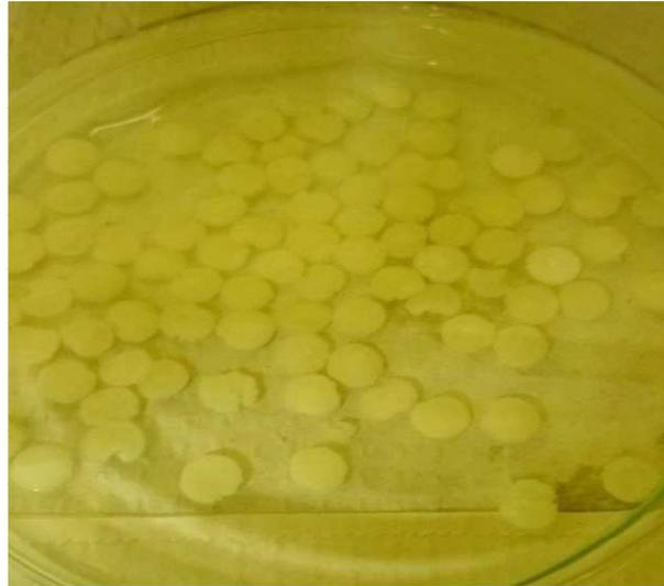
Figura 3. Imagem dos Arcabouços tridimensionais de Alginato de Sódio, Fibroína da Seda e Hidroxiapatita produzidos nesse estudo.
