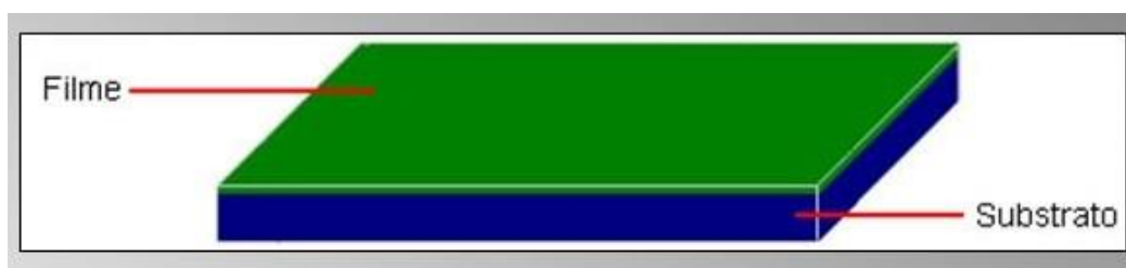
Figura 3 Esquema de filme depositado sobre um substrato
