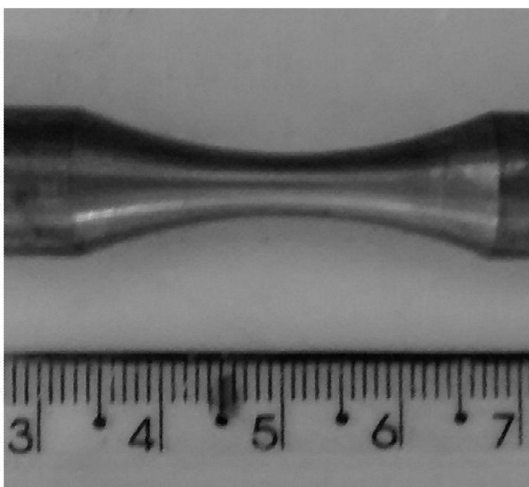
Figura 32. Corpo de prova após a oxidação por 10 h.
