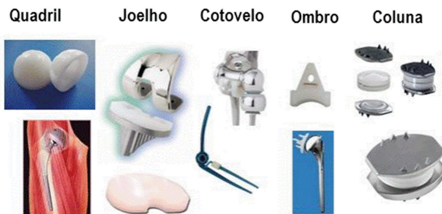
Figura 6 - Aplicações do PEUAPM no ramo biomédico ( http://www.notapositiva.com ).
