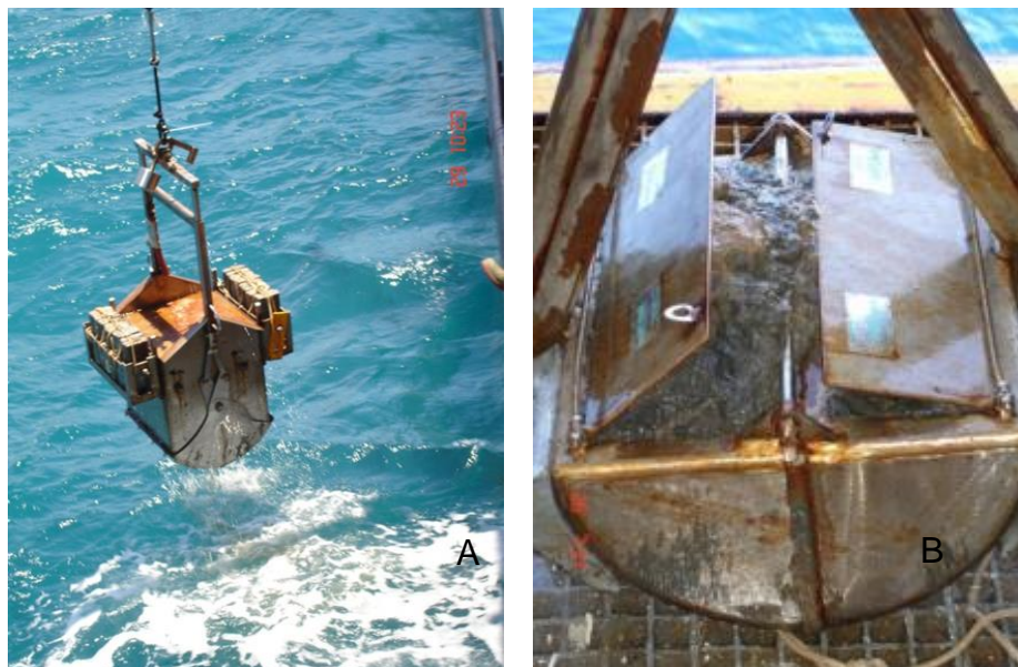
Figura 70 - Equipamentos de coleta de sedimentos: a) Box Core e b) Van Veen .
