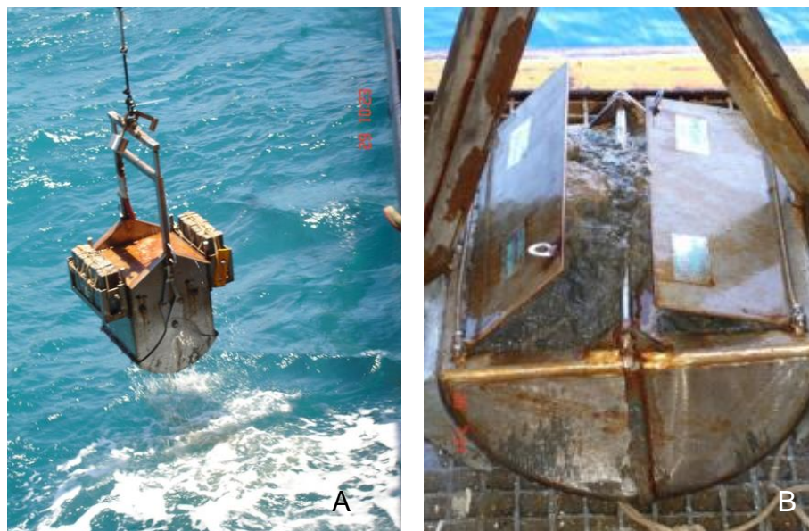
Figura 25 - Equipamentos de coleta de sedimentos: A) Box Core e B) Van Veen.
