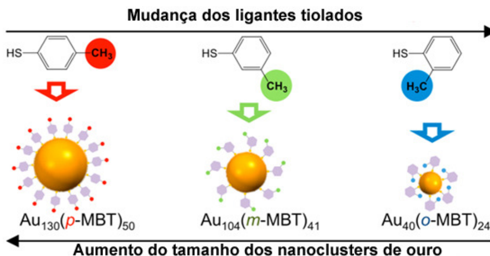
Figura 1.10. Metilbenzenotiol isoméricos para obtenção da síntese controlada de nanoclusters de \text{Au}_n(\text{SR})_m [89].
