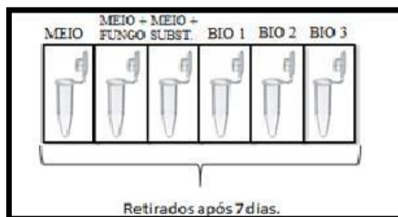
Figura 9: Representação do experimento de biotransformação para cada meio de cultivo e fungo. Eppendorfs para os controles (meio, meio + substrato e meio + fungo) e triplicatas da biotransformação BIO 1, BIO 2 e BIO 3 (meio + fungo + substrato).
