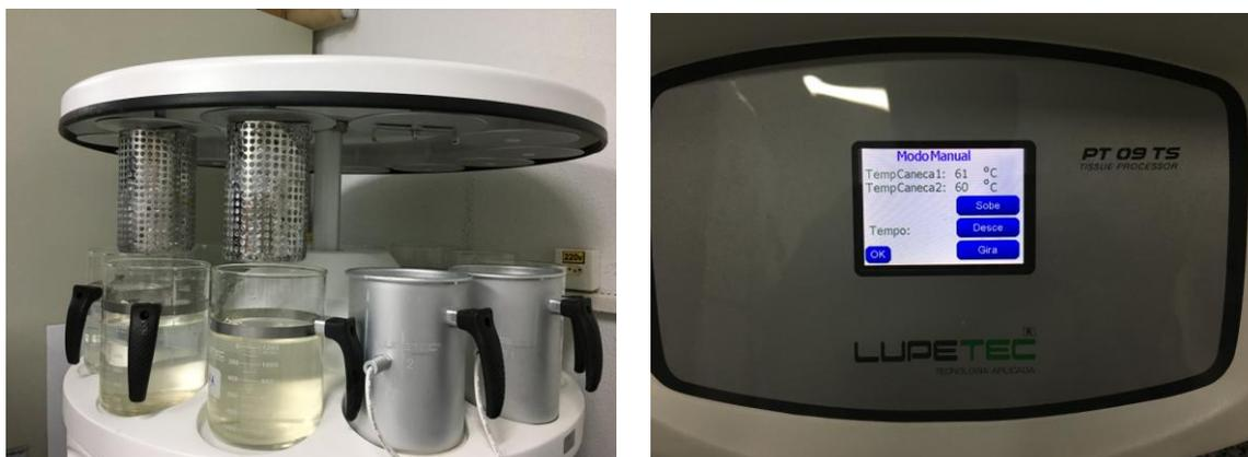
**Figura 10.** Processamento dos cortes dos órgãos e dos tumores no aparelho PT09TS Tissue Processor (LUPETEC®).
