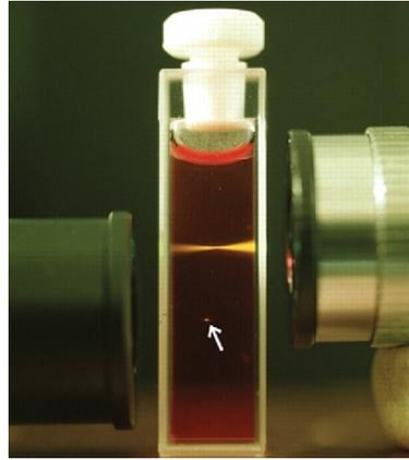
Figura 4 – Processo de emissão de fluorescência excitada via um fóton (iluminação superior) e via dois fótons (seta). Figura retirada da referência [79].
