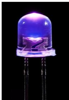
**Figura 3.13.** Diodo Emissor de Luz (LED).
