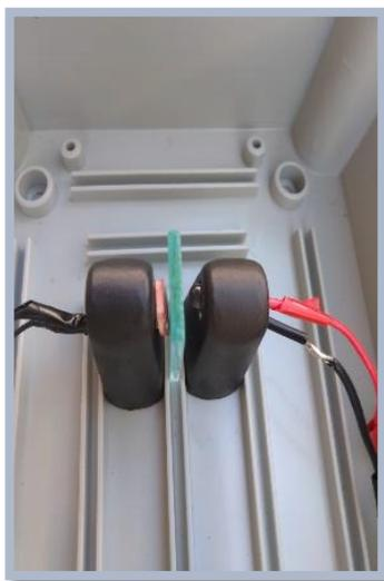
**Figura 23.** Posicionamento do porta-amostra.
