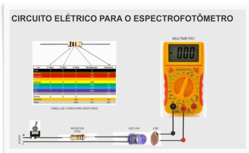
**Figura 3.15.** Circuito elétrico com imagens.
