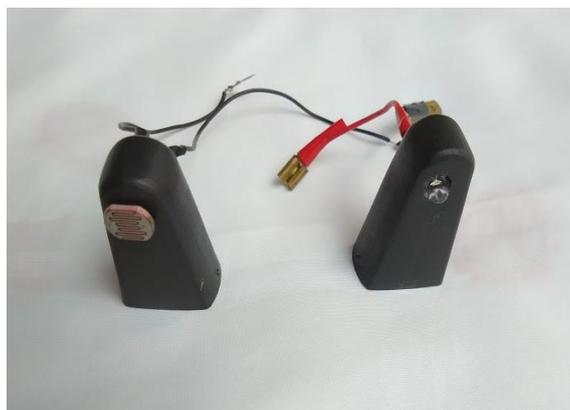
**Figura 13.5** Suportes com furações para posicionamento do LED e LDR.
