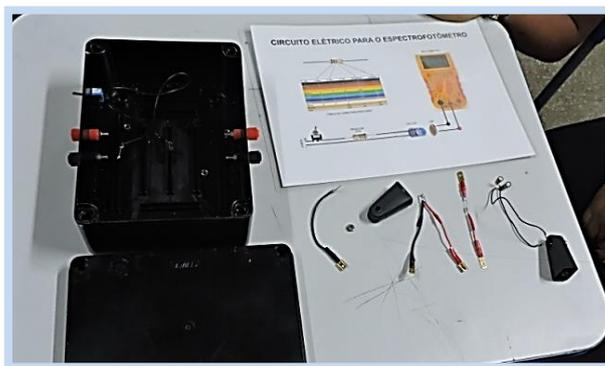
**Figura 18.** Kit de montagem do Espectrofotômetro.
