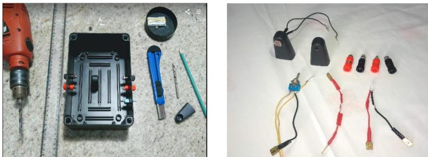
**Figura 13.3.** Materiais e ferramentas para perfurações na caixa. **Figura e 13.4** Componentes utilizados no espectrofotômetro.
