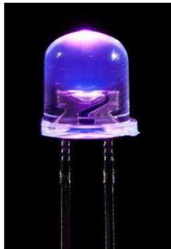
**Figura 14.** Diodo Emissor de Luz (LED).
