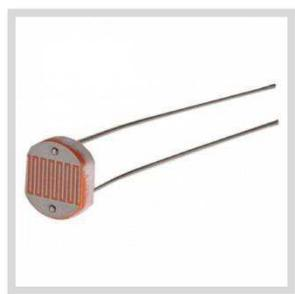
**Figura 13.** Resistor sensível à luminosidade (LDR).
