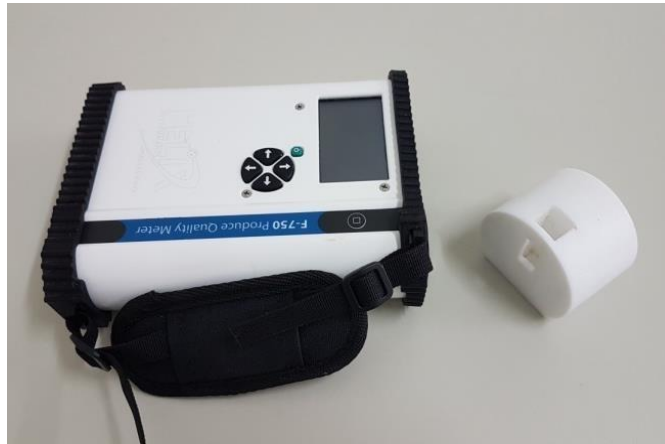
Figura 2 - Espectrômetro F-750 Produce Quality Meter (Felix Instruments, Portland, EUA) e adaptador (teflon) utilizado para inserir a cubeta com amostra.
