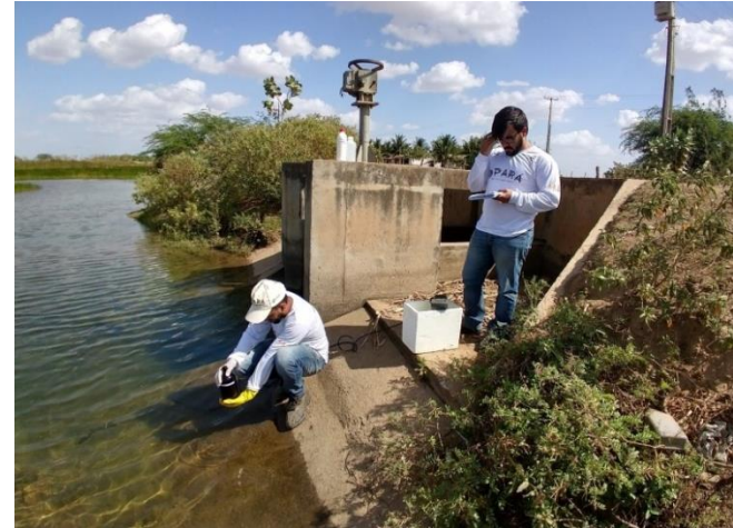
d) Procedimento de coleta de água na Calha Parshall
