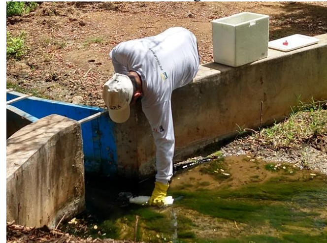
d) Procedimento de coleta de água na Calha Parshall
