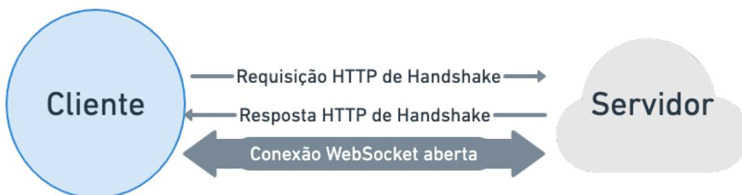
Figura 3 – Fluxo de uma requisição do protocolo WebSocket
