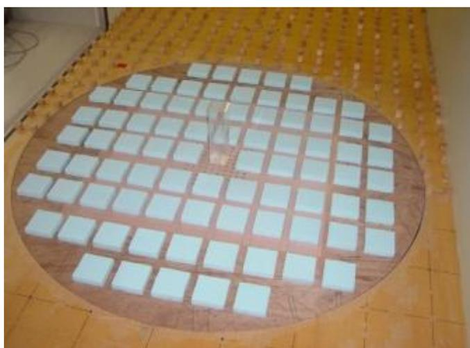
Figura 26 – Modelo utilizado nos ensaios de túnel de vento
