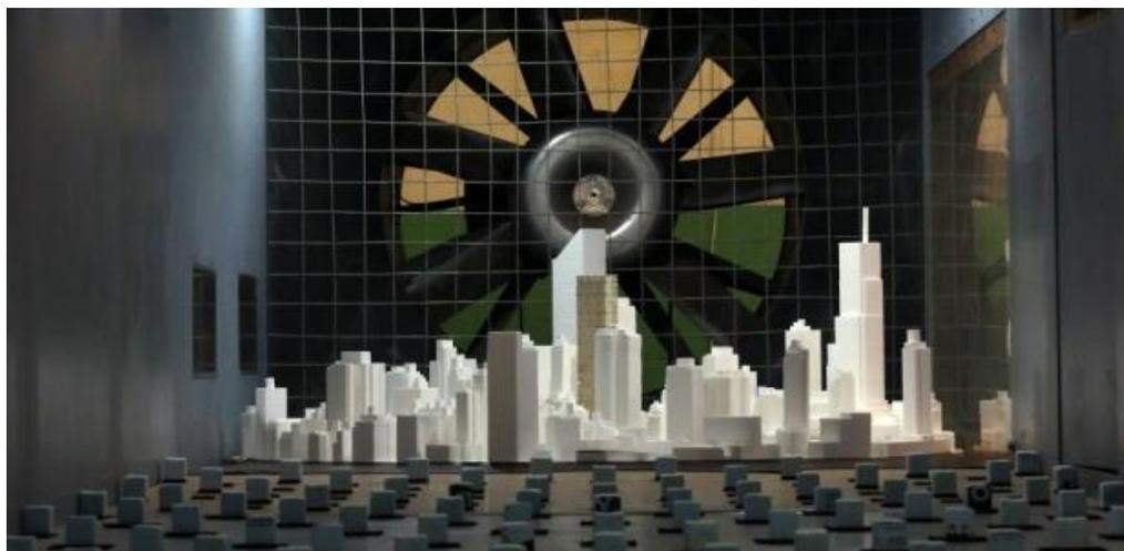
Figura 18 – Edifícios em teste no túnel de vento
