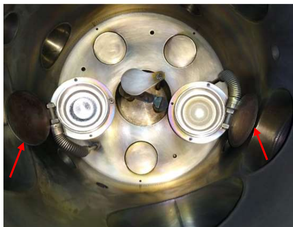
Figura 24: Imagem do interior da câmara de deposição a vácuo Orion 5-HV, AJA com os obturadores instalados sobre os alvos de Cr (à esquerda) e TiN (à direita).
