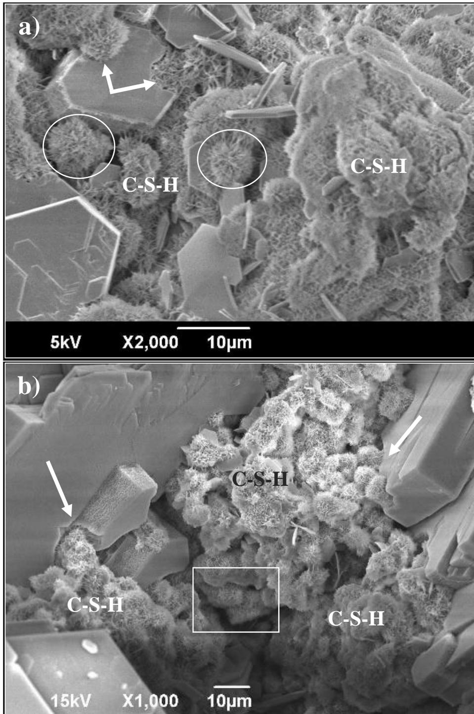
**Fig. 35.** Imagens (a e b) de MEV da pasta CT após 24 h de cura a 75 °C, ilustrando cristais grandes de portlandita (indicado pelas setas) em regiões densas de C-S-H fibrilar e “clusters” de C-S-H de forma esferulítica (indicado pelos círculos).
