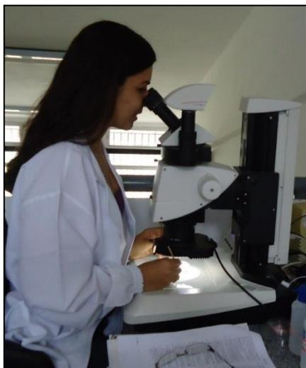
Figura 7. Triagem dos copépodes harpacticóides sob microscópio-estereoscópico para posterior identificação
