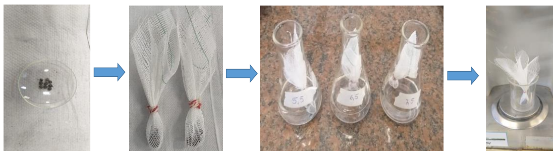
Figura 11: Esquema do procedimento experimental dos ensaios de intumescimento.
