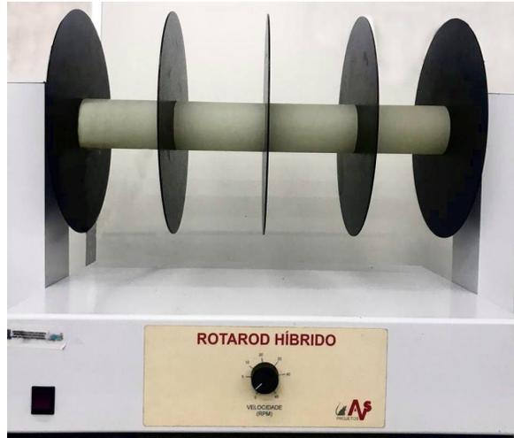
**Figura 8.** Rota Rod utilizado para avaliar a coordenação motora de animais. Fonte: Arquivo do Laboratório de Pesquisa em Neurociência - LAPENE.
