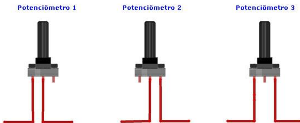
Figura 4-6. : Ligações de um potenciômetro. Disponível em http://www.comofazerascosas.com.br/potenciometro-o-que-e-para-que-serve-e-como-funciona.html , acesso em 20/01/2020.
