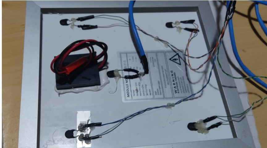
Figura 32 – Termistores aplicado no modulo solar
