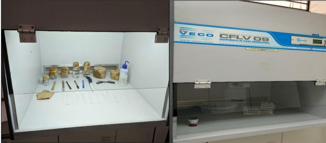
**Figura 12** - Capela de Fluxo Laminar utilizada nos experimentos. **Fonte:** O autor.
