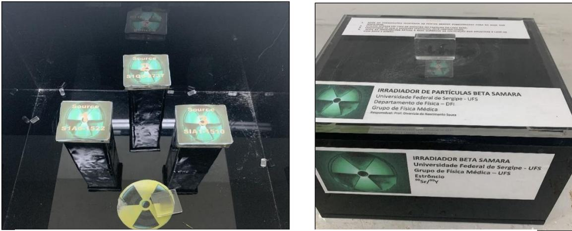
**Figura 14** - Irradiador Samara com fontes de  $^{90}\text{Sr}+^{90}\text{Y}$ . **Fonte:** O autor.
