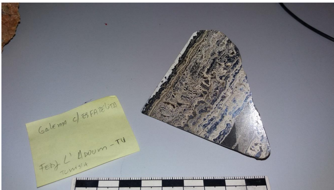
Figura 1 – Fotografia de amostra de galena com esfarelita, coletada em Fedj el Adoum, Tunísia.
