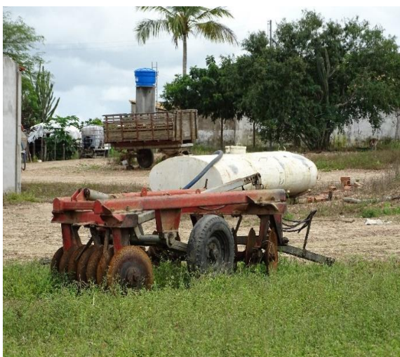
Grade de tombar terra, pipa e carreta para transporte de água e produtos.
