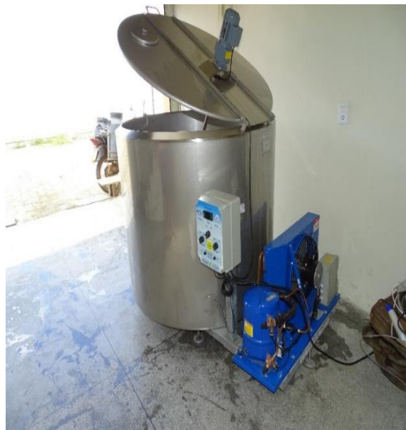
Figura 51: Tanque de resfriamento de leite no Sertão Sergipano, 2020
