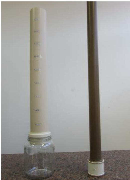
**Figura 4** – Aparato usado no experimento de lixiviação. **Fonte:** Aatoria Própria
