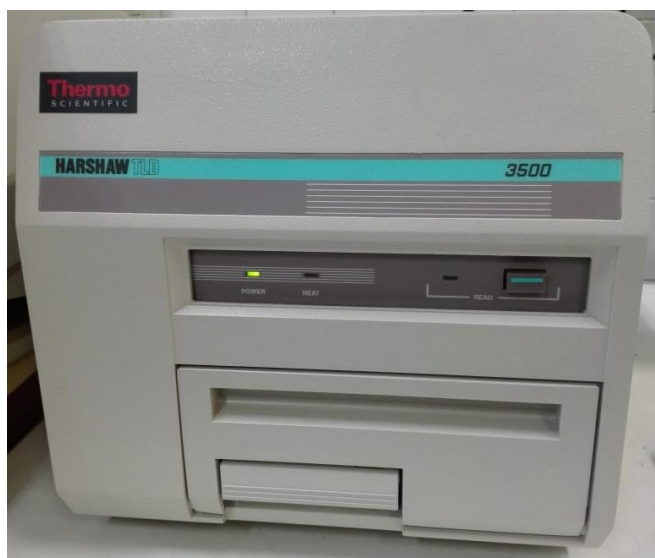
Figura 20. Leitoras TL da Harshaw da Thermo Scientific do LCI/GMR/IPEN.
