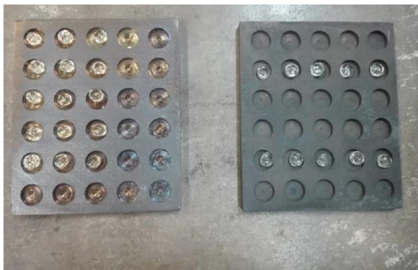
Figura 16. Placas de alumínio utilizadas para tratamento térmico das pastilhas de 80MBO e 60MBO.
