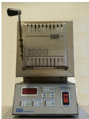
Figura 12. Forno utilizado para a fundição dos compostos vítreos. (EDG-1800).
