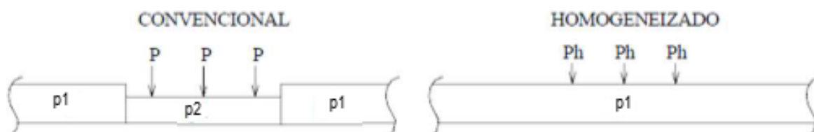
Figura 4 – Comparação do trem-tipo convencional com o homogeneizado
