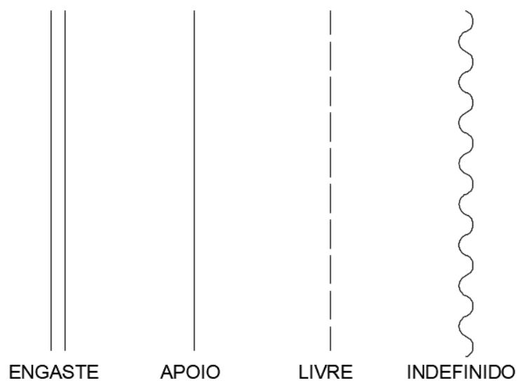
Figura 10 – Condições de contorno da laje
