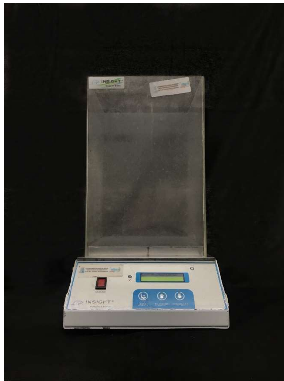
Figura 4. Placa Quente. A plataforma quente é utilizada para investigação da latência térmica dos animais. Acervo do Laboratório de Pesquisa em Neurociências – UFS.
