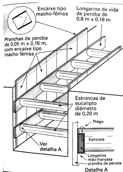
Figura 5 - Escoramento tipo especial
