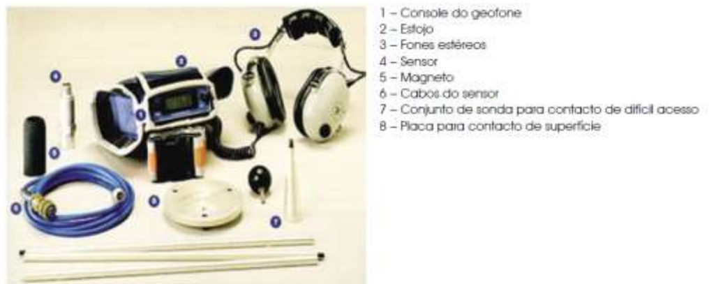
Figura 11 - Geofone e suas partes constituintes
