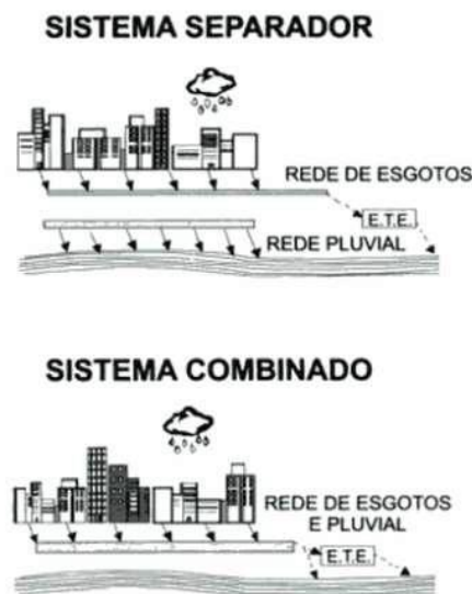
Figura 2: Sistemas coletivos de coleta de esgoto
