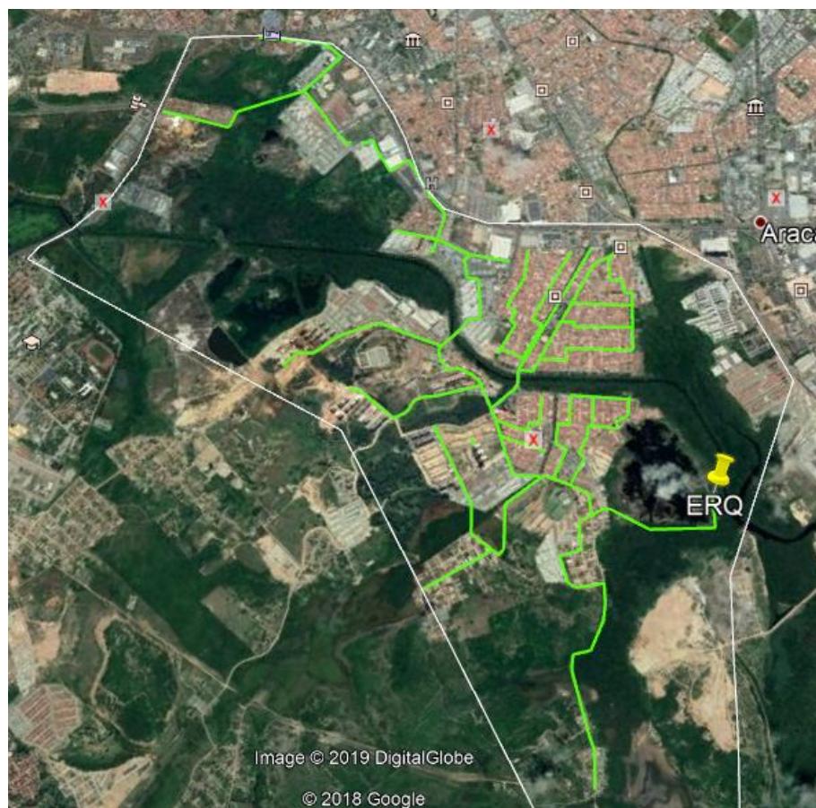
Figura 22: Traçado da rede coletora centralizada
