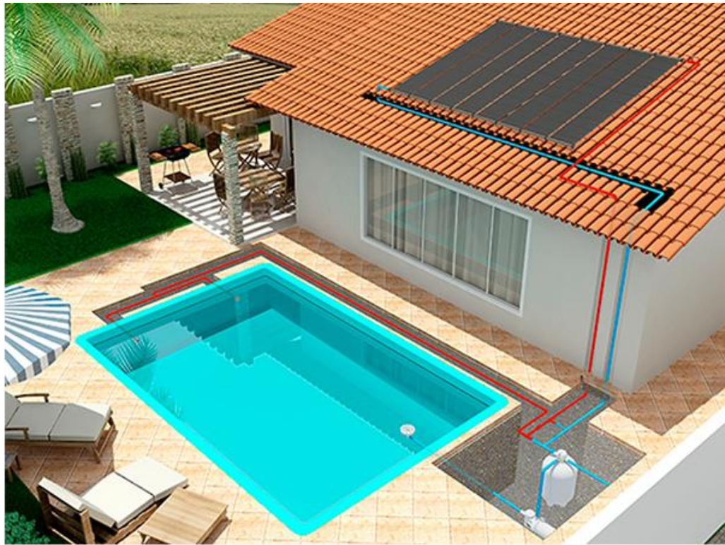
Figura 8 – Sistema de aquecimento de piscina através de coletores solares
