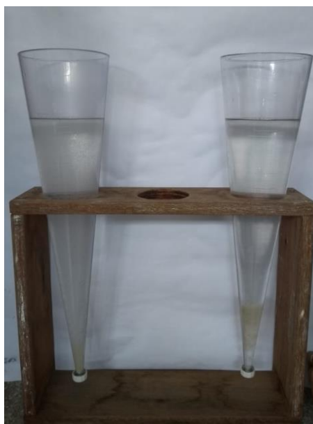
Figura 16 - Cone Imhoff com as amostras da água bruta com o coagulante natural (à esquerda) e com o coagulante químico (à direita).
