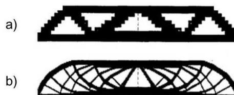
Figura 2.3: (a) Malha discretizada em 600 elementos; (b) Malha discretizada em 5400 elementos.
