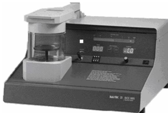
Figura 15: Equipamento utilizado para recobrimento com carbono ou deposição metálica sobre as amostras não condutoras.
