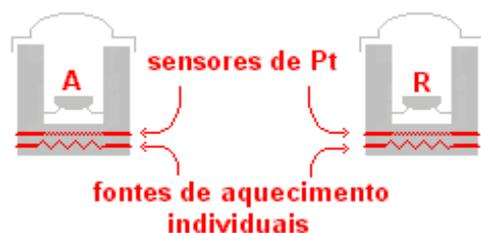
Figura 17: Diagrama esquemático dos compartimentos do DSC por compensação de energia
