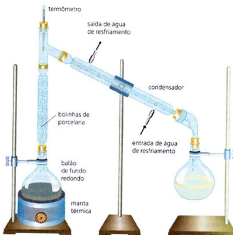
Figura 1 - Aparelho de destilação por arraste de vapor tipo Clevenger marca Marconi, modelo MA480 (Adaptado SILVA et al. , 2010).
