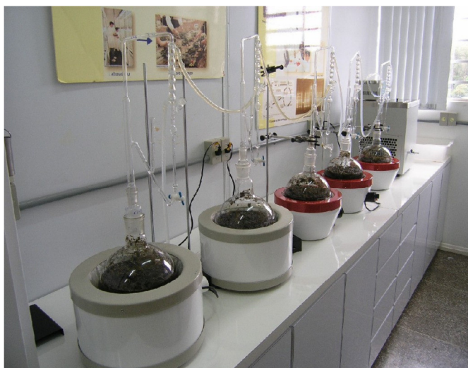
Figura 2 –Aparato utilizado para extração de óleos essenciais por hidrodestilação (BUSATTA, 2006).
