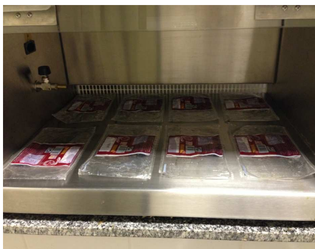
Figura 9. Embalagens de polietileno de alta densidade esterilizadas em câmara ultravioleta.
