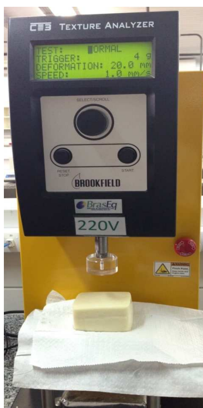
Figura 12. Posicionamento da probe para análise de TPA (Texture Profile Analysis- Análise do perfil de textura).
