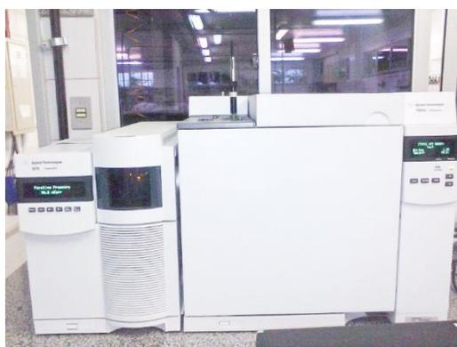
**Figura 9** – Sistema de cromatógrafo a gás e espectrômetro de massas (Agilent, 7890A/5975C GC/MS). Fonte: Autoria própria.
