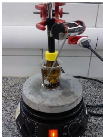
**Figura 8** – Sistema de isolamento dos compostos voláteis do óleo extraído de sementes de graviola, utilizando-se a técnica HS-SPME. Fonte: Autoria própria.
