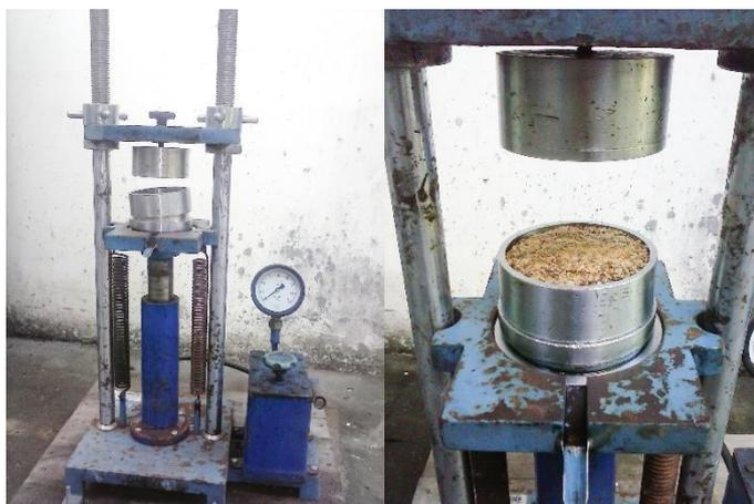
**Figura 7** – Prensa hidráulica utilizada para a extração do óleo de sementes desidratadas de graviola por prensagem a frio.
