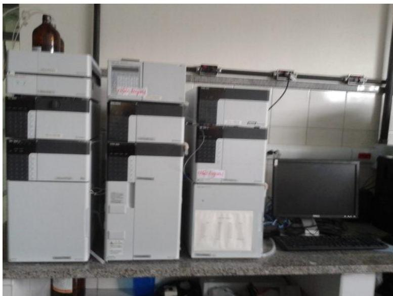
**Figura 03:** Sistema de cromatografia líquida de alta eficiência acoplada com detectores (Shimadzu). Fonte: o autor
