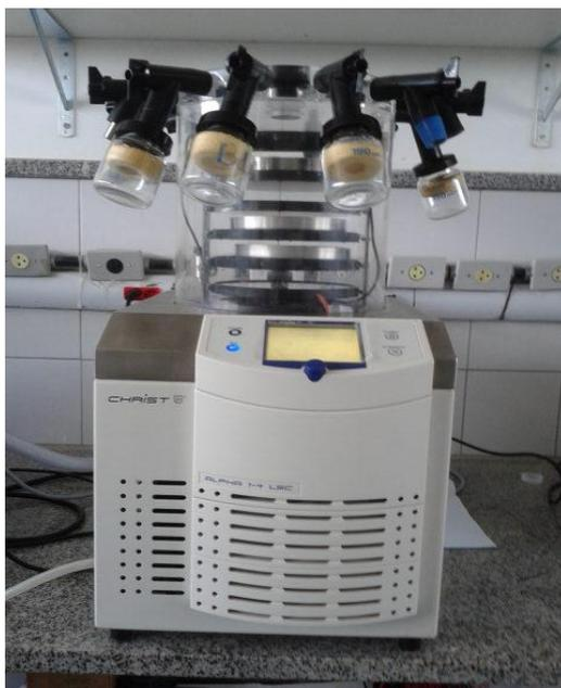
**Figura 02:** Equipamento liofilizador (Christ, modelo Alpha 1-4 LSC). Fonte: o autor
