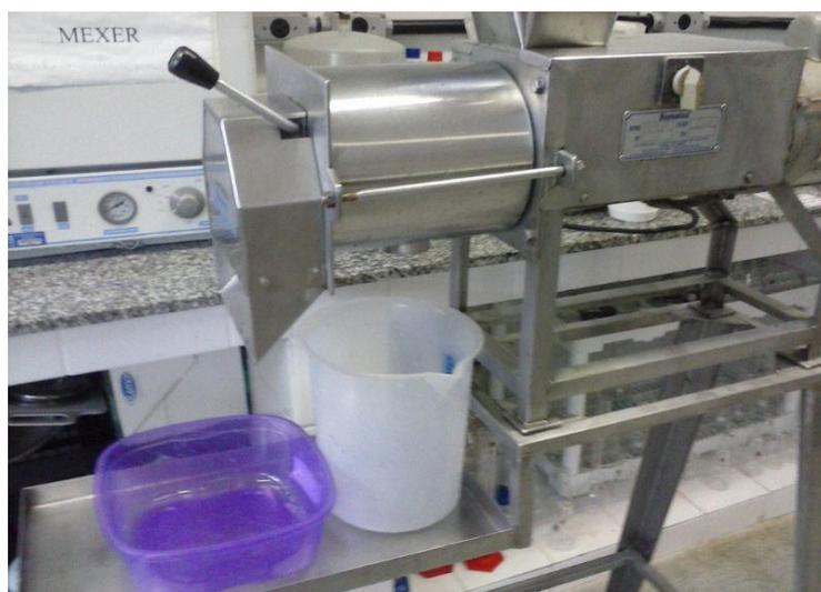
**Figura 06:** Despulpadeira mecânica (Itametal, modelo Compacta 189). Fonte: o autor
