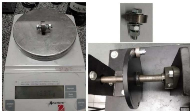
Figura 32 – Detalhes do contrapeso adicionado ao volante para simular a condição de desbalanceamento do conjunto.
