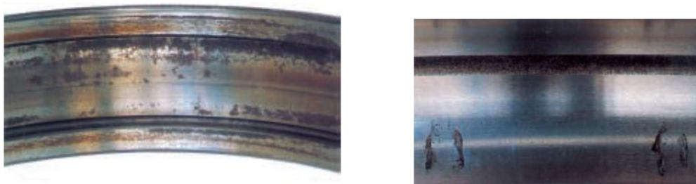
Figura 22 - Oxidação na face do rebordo, na superfície da pista e no espaçamento das esferas (adaptado de NSK – 2013).
