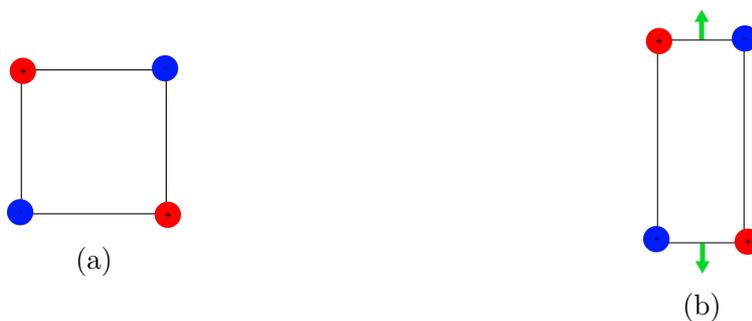
Figura 2.3: Estrutura atômica tetragonal (a) em repouso, (b) sob ação de uma força, em verde.
