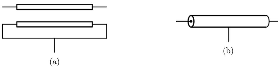
Figura 2.21: Símbolos esquemáticos equivalentes à linha de transmissão com nós N2 e N4 conectados baseado na (a) representação gráfica de um par de condutores, (b) representação gráfica de um cabo coaxial.
