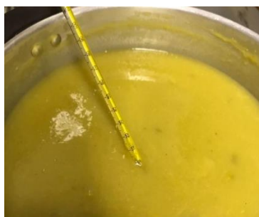
Figura 3. Realização da pasteurização lenta da polpa de umbu a 65^{\circ}\text{C} \pm 1^{\circ}\text{C}/30 min.
