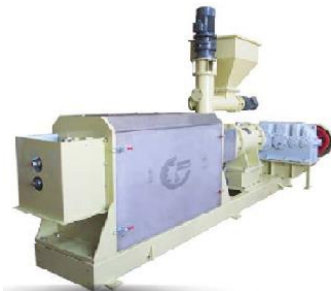
Figura 5. Prensa contínua para extração de óleos de sementes de girassol, milho, soja e colza.
