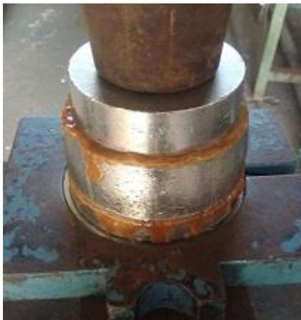
Figura 7- Prensa hidráulica (modelo SIWA 60T, Brasil) utilizada na obtenção do óleo da pimenta rosa
