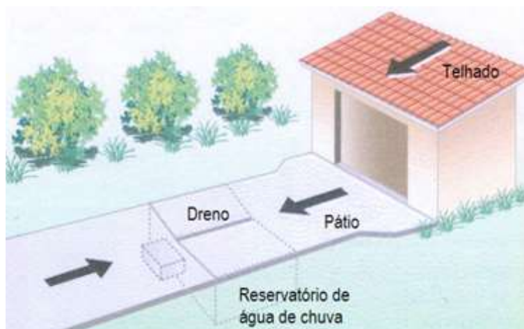
Figura 6 – Área de coleta em telhado e pátio.
