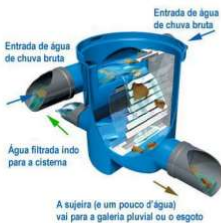
Figura 13 – Filtro para retenção de materiais grosseiros.
