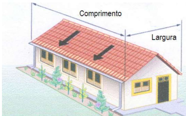
Figura 4 – Área de coleta em telhado.
