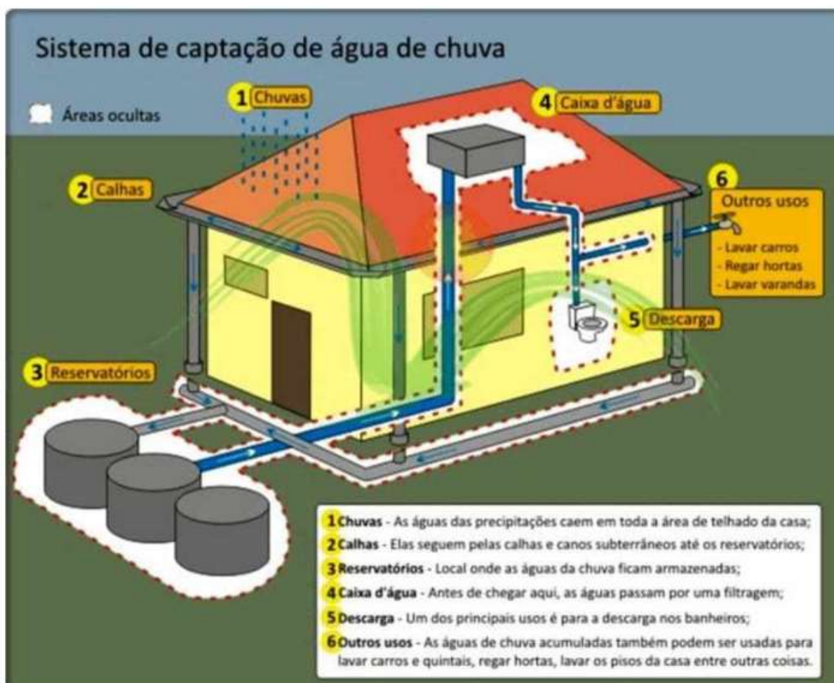
Figura 3 – Esquema de um SCAP para reservatório.
