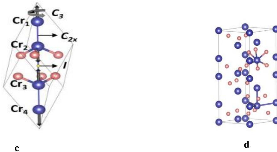
**Figura 2: (a) pó de  $\text{Cr}_2\text{O}_3$ , (b) estrutura química, (c) fase romboédrica, e (d) fase hexagonal do  $\text{Cr}_2\text{O}_3$**
