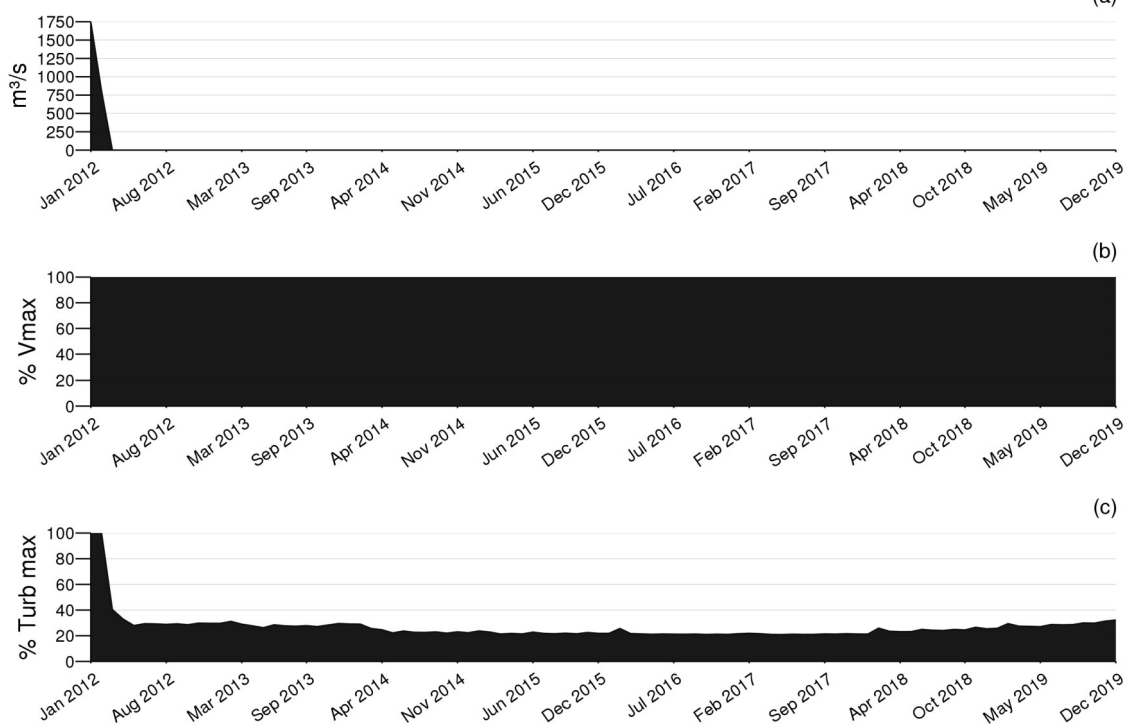
Apêndice AC - Operação em PNL do Complexo Paulo Afonso / Moxotó: (a) vertimento, (b) armazenamento (fração do máximo) e (c) turbinamento (fração do máximo) - Cenário III
